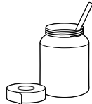
Sello para las uniones de cañerías
